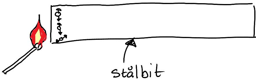
När lågan når stålbiten överförs värmeeenergin till rörelseenergi. Rörelsen sprids i materialet och ju tätare ett material är desto bättre leds värmen.
